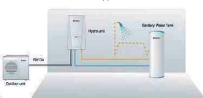
ОБОГРЕВ/ОХЛАЖДЕНИЕ С ГОРЯЧИМ ВОДОСНАБЖЕНИЕМ
