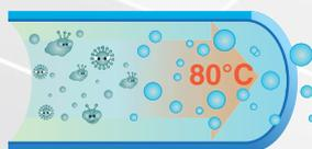
Нагрев воды в баке до температуры 70°C уничтожает большую часть бактерий, находящихся в водопроводной воде. Бак изготовлен из нержавеющей стали и не подвержен коррозии.
